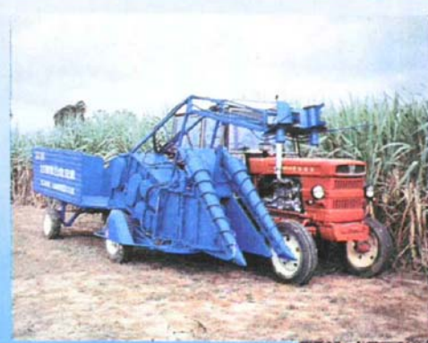
4G265整杆剥叶型甘蔗联合收获机
