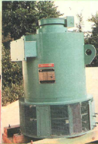
TW220-8-TH 无换向器调速电机
